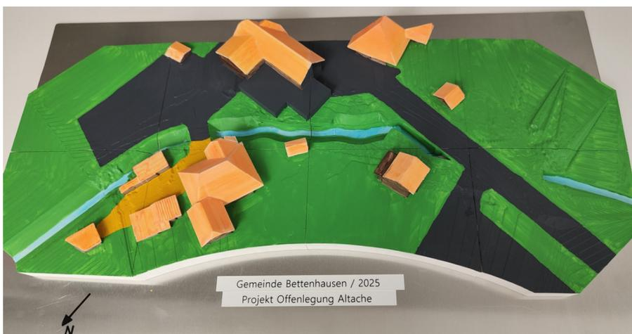
Das 3D-Modell zeigt anschaulich die geplante Offenlegung des 132 Meter langen Durchlasses des Altachekanal beim ehemaligen Restaurant Rössli. Das Bauwerk ist in schlechtem Zustand und darf gemäss Gewässerschutzgesetz nicht mehr eingedolt bleiben, wenn bauliche Massnahmen ergriffen werden müssen. Eine Offenlegung bringt ökologische Vorteile, wird vom Kanton unterstützt und fördert die Biodiversität.
